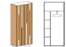
Внутренний каркас – ламинированная ДСП 18 мм, кромка ABS 0,8 мм. Наружные декоративные боковые панели – плита МДФ 12 мм, облицованная шпоном, кромка – натуральный шпон. Задняя стенка – плита ДСП 18 мм. В основании каркасов установлена цокольная коробка из плиты ДСП 18 мм. Опоры шкафа имеют регулировку по высоте: 0 - 12 мм.
